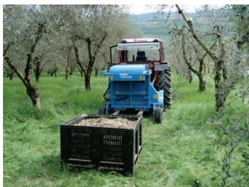
Figura 3.5 Macchinari per la trinciatura e il recupero dei residui di potatura.
