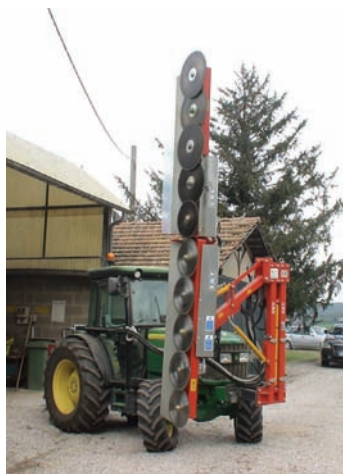
Figura 3.4 Tecnologie per la potatura meccanica in continuo; sulla sinistra barre a dischi portate da trattore, sulla destra macchinario semovente Speedy Cut.
