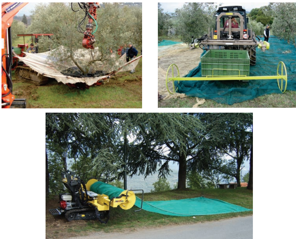
Figura 3.16 Tecnologie per il recupero delle olive; in alto a sinistra ombrello rovescio dotato di sistema di aspirazione e serbatoio di accumulo, sulla destra ed in basso due diverse configurazioni del sistema di intercettazione a bobina.
