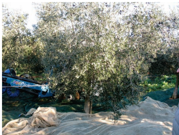
Figura 2.7 Olivo allevato a monocaule a chioma libera in fase di raccolta con vibro-scuotitore del tronco.
