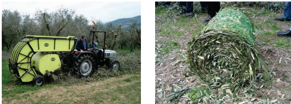
Figura 3.6 Rotoimballatrice per la gestione dei residui di potatura delle colture arboree, sulla destra rotoballa di ramaglie di olivo prodotta dalla macchina.
