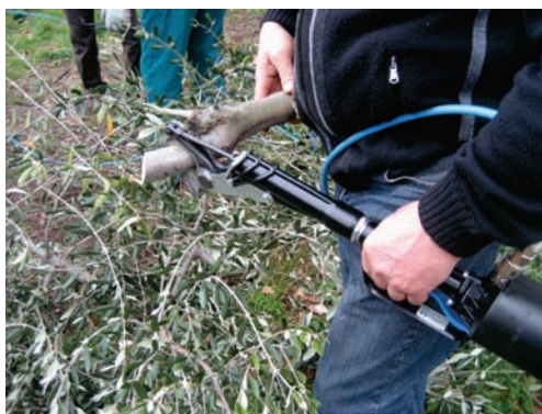
Figura 3.3 Troncarami fisso e telescopico ad azionamento pneumatico.
