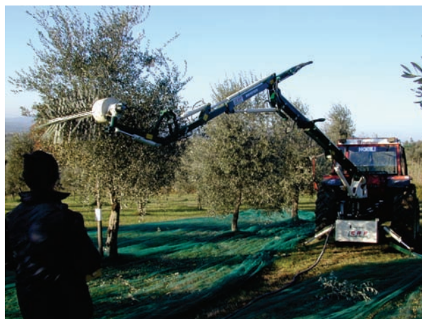
Figura 3.14. Pettinatrice dotata di movimento elettroidraulico del pettine bacchiante.
