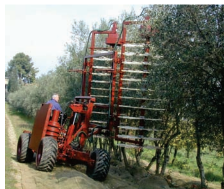
Figura 3.10 Primi prototipi italiani per la raccolta laterale in continuo mediante pettinatura ( in alto e in basso a sinistra); sulla destra odierna evoluzione della tecnologia.
