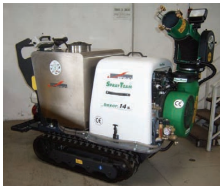
Figura 3.9 Innovative tecnologie per la difesa antiparassitaria; a sinistra quad dotato di modulo irrorante, sulla destra atomizzatore a cannone allestito su minicingolato.
