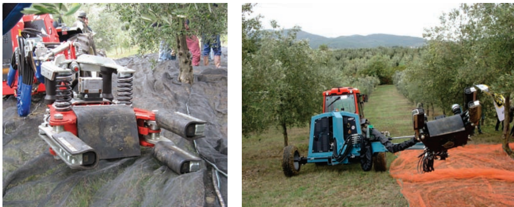
Figura 3.13 Scuotitori dotati di pinze con ganasce in contrapposizione delle ditte Berardinucci e SPEDO.
