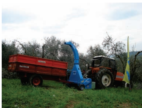
Figura 3.5 Macchinari per la trinciatura e il recupero dei residui di potatura.
