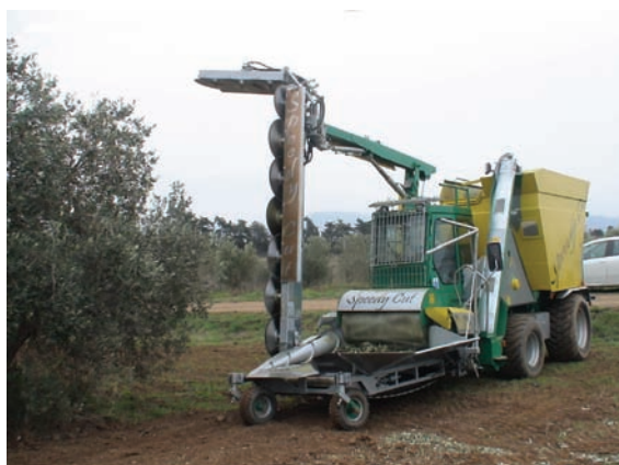
Figura 3.4 Tecnologie per la potatura meccanica in continuo; sulla sinistra barre a dischi portate da trattore, sulla destra macchinario semovente Speedy Cut.
