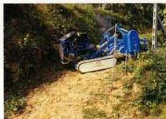
Figura 28 La maggior potenza disponibile permette l' utilizzazione di un trinciastocchi con un fronte di lavorazione pari alla larghezza dell' unità motrice.
