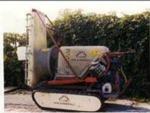
Figura 27 Il prototipo su cui è applicato un gruppo di irrorazione ad aeroconvezione.
